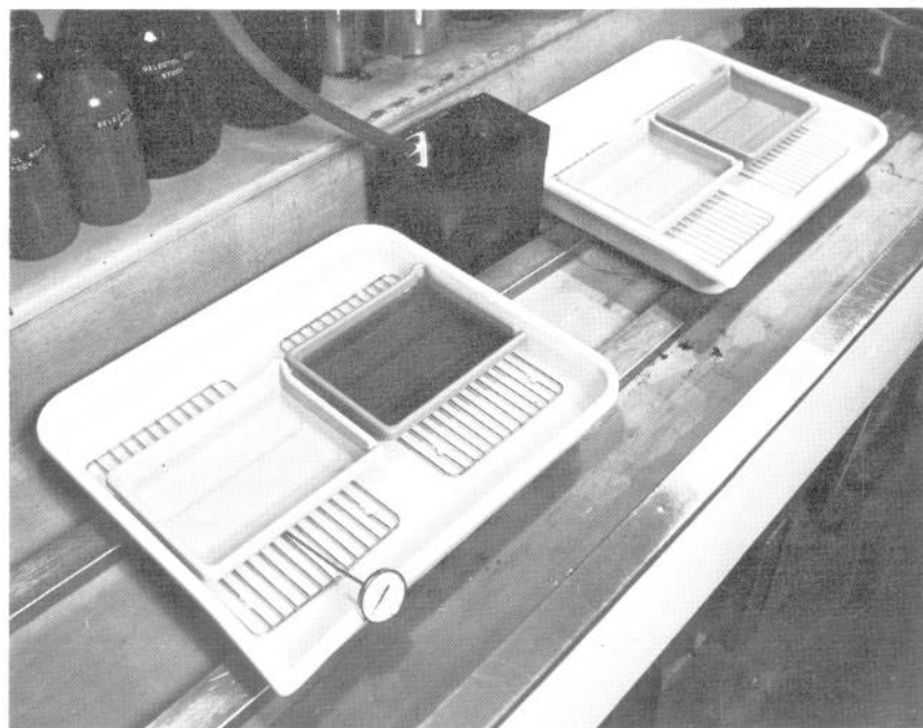
Figura 9-3. Cubetas al baño María para el control de la temperatura. El uso de grandes cubetas como recipientes para el "baño María" permite controlar la temperatura durante el revelado. Las cubetas de procesado se colocan sobre rejillas que permiten que el agua a temperatura controlada circule por debajo de ellas. De izquierda a derecha, las cubetas de procesado corresponden al remojo inicial en agua, revelador, baño de paro y fijador. El tanque grande contiene agua fría para remojar las manos antes de manipular las películas en el revelador, ya que el calor de las manos puede hacer que la temperatura del revelador se eleve varios grados durante el procesado.
